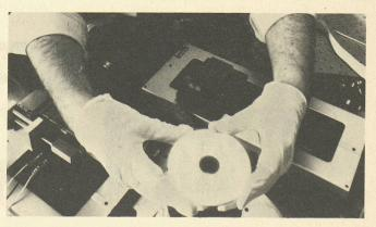
L'un des chercheurs d'IBM en train de tester son disque expérimental à la surface duquel les pistes d'enregistrement n'ont qu'un demi-millième de millimètre de largeur.
