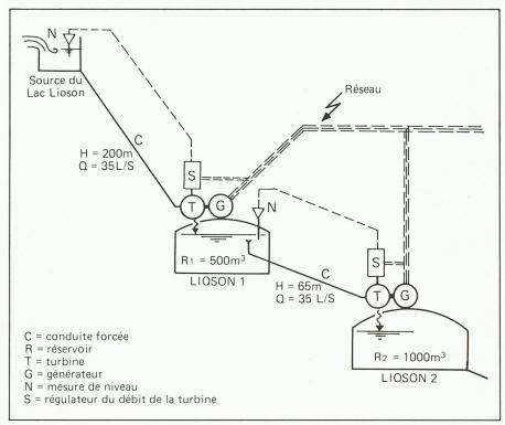
Fig. 7. - Microcentrale sur adduction d'eau potable.
