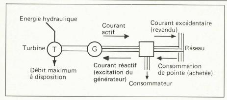
Fig. 1. - Fonctionnement en parallèle sur le réseau.
