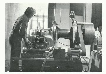
Fig. 8. - Turbine Kaplan simplifiée de 40 kW en atelier.
