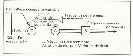
Fig. 2. - Fonctionnement en îlot, avec régulation fréquence/débit.
