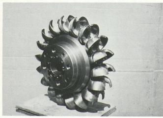
Fig. 5. - Turbine Pelton de 50 kW dans une adduction d'eau potable.
