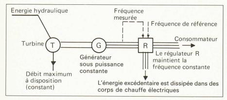
Fig. 3. - Fonctionnement en îlot, avec régulation charge/fréquence.
