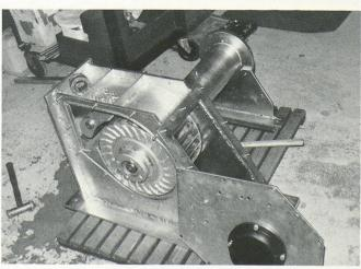
Fig. 6. - Turbine à flux traversant de 30 kW en atelier.
