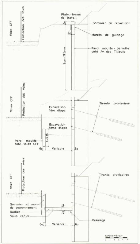
Fig. 22. - Evolution des travaux le long de l'avenue des Tilleuls.
