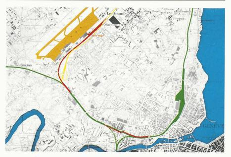
Au départ de la gare de Genève, cette nouvelle voie longe, côté nord, la double voie de la ligne Genève-Aéroport, puis elle s'enfonce progressivement jusqu'à être complètement souterraine sur une longueur de 830 m. Cette galerie passe, par un saut-de-mouton, sous les voies CFF du raccordement à l'aéroport, qu'elle longe ensuite, côté sud. Elle vient enfin se raccorder au tunnel de Châte-
