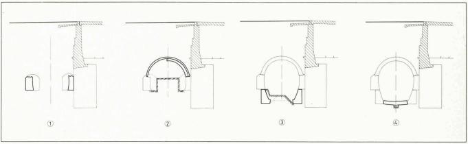
Fig. 10. - Les phases d'exécution du tunnel.
