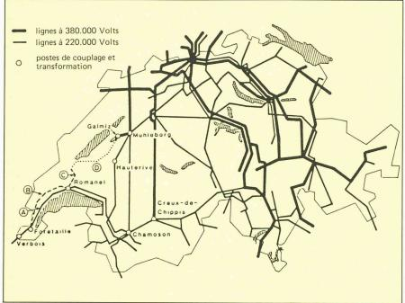
Réseau suisse à très haute tension et projet d'extension à 380 kV en Suisse romande. A — Ligne existante à 220 kV Romanel-Verbois alimentant en priorité le canton de Genève. B — Ligne existante à 125 kV alimentant l'ouest du canton de Vaud à transformer sur le même tracé en ligne à 380 kV. C — Ligne existante à 125 kV à transformer en ligne à 380 kV entre Romanel et Bavois.
