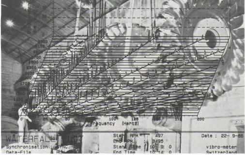
Présentation graphique spatiale de vibrations. On distingue au fond une unité de pompage-turbinage. (Photo: Vibro-Meter SA.)
