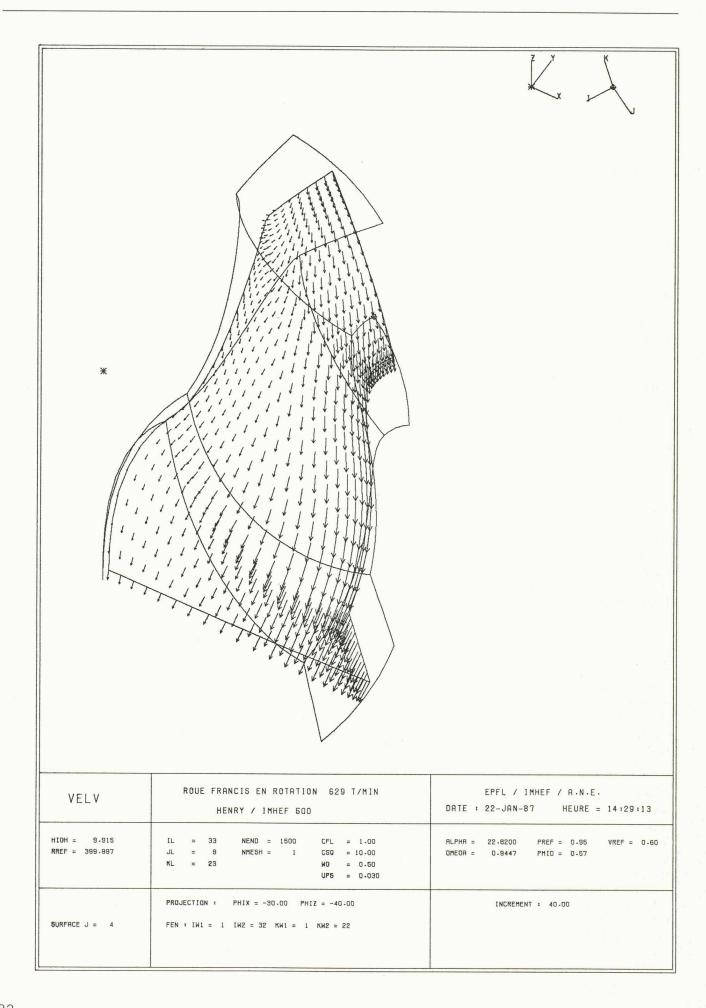
◀ Fig. 1: Champ de vitesse relative de l'écoulement sur une surface gauche (ici projetée) entre deux aubages successifs d'une roue de turbine FRANCIS en rotation.
