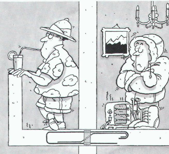
Comparé à l'acier de construction avec une conductivité thermique de 52 W/m<sup>2</sup> K, notre raccord de dalle en construction en acier au molybdène-chlorure de nickel, V4A ou V2A, n'a que 15 W/m<sup>2</sup> K.
