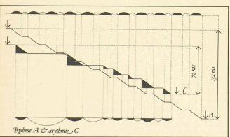
Fig. 4. — Profil d'un escalier romain (A) et de l'« escalier Calvin » (C), illustrant le contraste entre un escalier bien rythmé et l'arythmie de l'autre, la dénivellation étant seulement de 72 marches.
