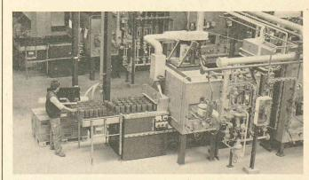
Vue partielle de l'installation de production de catalyseurs pour les gaz d'échappement des automobiles dans l'usine Degussa de Rheinfelden. (Photo: Degussa.)
