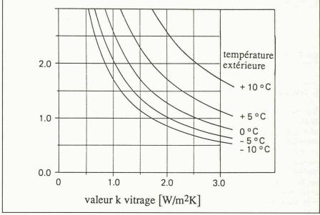
Fig. 2. — Hauteur maximale admissible d'une fenêtre sans radiateur sous la fenêtre ( $V_{air}$  admissible = 25 cm/s).
