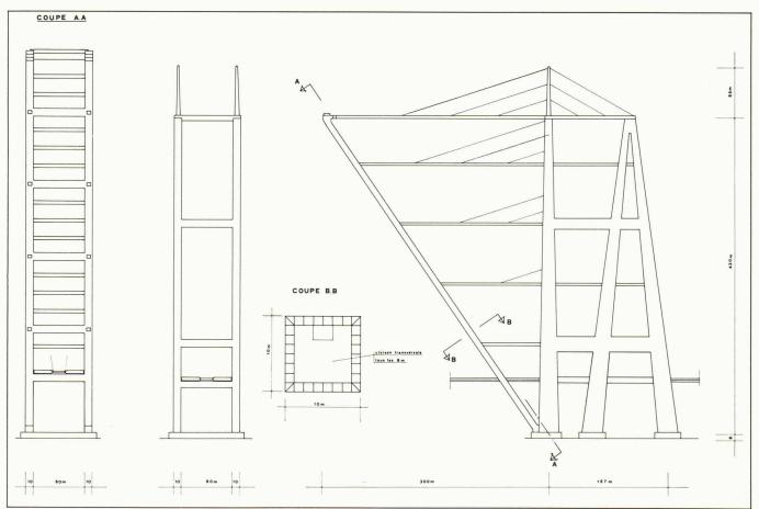
Fig. 11. - Disposition d'un pylône.
