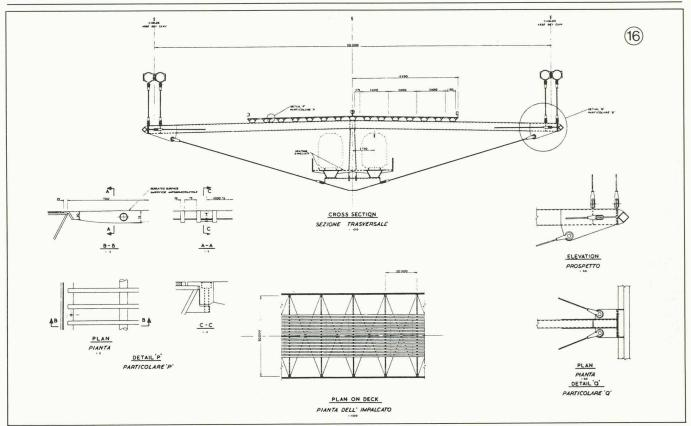
Fig. 3. – La conception du tablier proposée par GPM.
