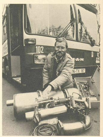
Les autobus urbains à moteur diesel livrés par la maison MAN GmbH, de Nuremberg, sont actuellement équipés de nouveaux filtres spéciaux capables de réduire de 80 % les émissions de suie dans les gaz d'échappement.
