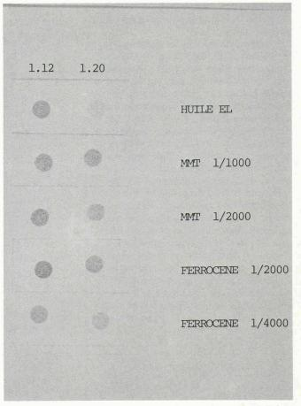
Fig. 3. – Photographie de prélèvements de suie (test Bacharach). Huile extra-légère, MMT et ferrocène. Chaudière Cipag – brûleur Cuenotherm –  $39 \text{ kW} - \lambda = 1,12 \text{ et } 1,20.$
