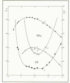
Fig. 4. – Variation des niveaux de  $NO_x$  et de CO avec le coefficient d'air  $\lambda$ . Echantillon 32 à 2% d'eau – Chaudière Strebel – brûleur Cuenotherm – 39 kW.
