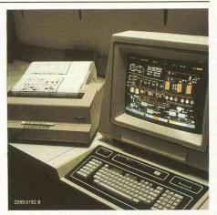
Fig. 9. — Poste de commande régissant la centrale énergétique, équipé d'un terminal couleur et d'un traceur.
