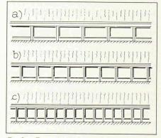
Fig. 3. — Exemples de faces, côté aval de galerie avec espacement des piliers de : a) 8,00 m, baies en forme de rectangle couché : impression dynamique; b) 5,00 m, forme des baies voisine du carré : impression statique; c) 3,00 m, baies en forme de rectangle debout : impression de stabilité.
