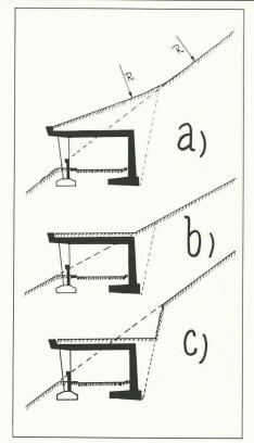
Fig. 2. — Couche des terres rapportées sur la toiture de la galerie: a) raccordée harmonieusement au versant naturel; b) présentant une rupture de pente disgracieuse; c) comportant un décrochement de terrain inesthétique.
