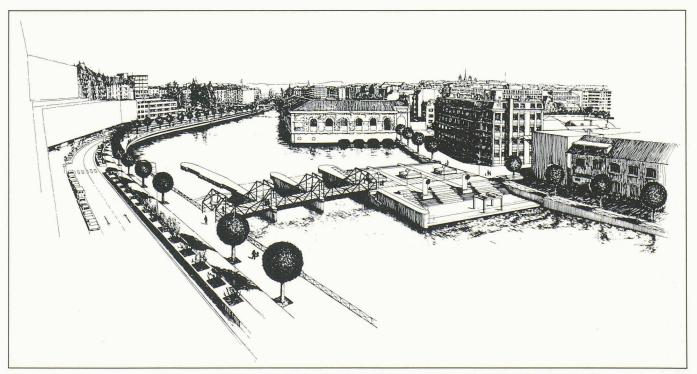
Fig. 4. — Perspective du nouvel ouvrage, vue d'aval. De gauche à droite: la passe-écluse, les passes du barrage, l'usine hydro-électrique.
