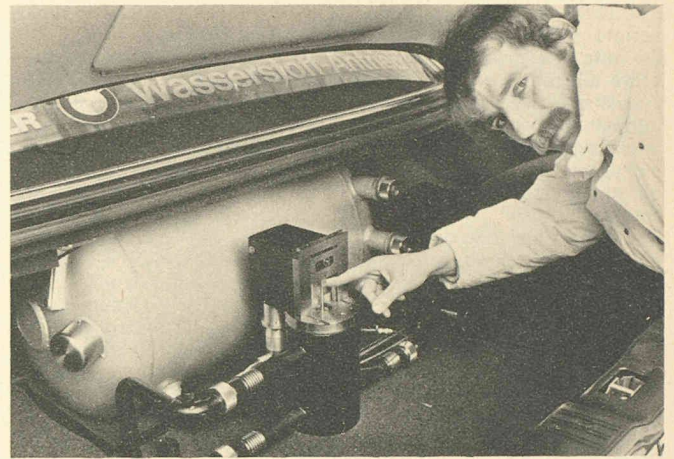
«Rouler en voiture à l'hydrogène – la voiture propre de l'avenir» – tel était le thème d'un récent symposium qui s'est déroulé à Hambourg. Notre photographie montre le réservoir d'une telle voiture propulsée à l'hydrogène portant une marque illustrée dans le domaine de l'innovation technique: BMW (Bayerische Motoren-Werke).
