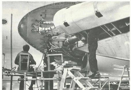
La structure qu'il s'agit d'inspecter est encombrée de kilomètres de câbles et de conduites ainsi que d'innombrables pièces d'équipement, fixes ou mobiles; ici, c'est la partie avant de l'emplanture de l'aile qui est soumise à inspection périodique.
