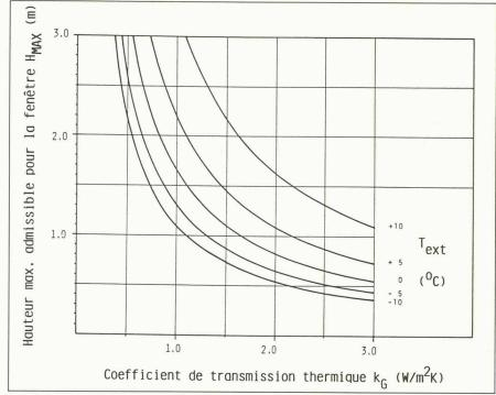
Fig. 3. — Hauteur maximale des fenêtres  $H_{max}$  telle que la vitesse de l'air à proximité de la fenêtre soit inférieure à 0,2 m/s, en fonction du coefficient de transmission thermique k des fenêtres.
