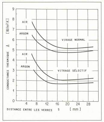
Fig. 4. – Transfert de chaleur dans l'espace entre les deux verres pour un vitrage normal ( $\varepsilon = 0.84$ ) et pour un vitrage s'électif ( $\varepsilon_1 = 0.84$ ,  $\varepsilon_2 = 0.10$ ).
