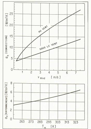
Fig. 2. — Coefficient de transfert de chaleur vers l'extérieur (convection et ravonnement).
