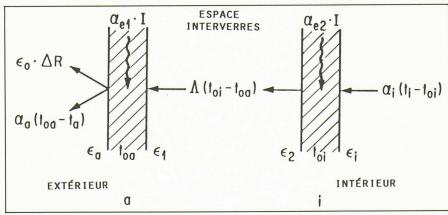
Fig. 1. - Flux de chaleur avec un vitrage double.
