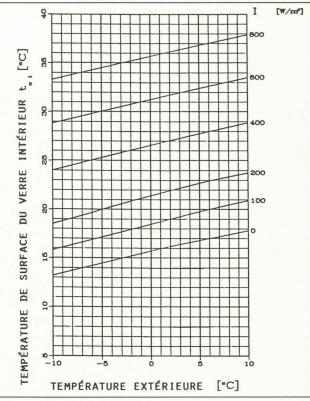
Fig. 5. — Diagramme donnant la température du verre intérieur d'un ver re sélectif isolant de type confort (4/15/4 mm), valable pour  $t_i = 20$ °C.
