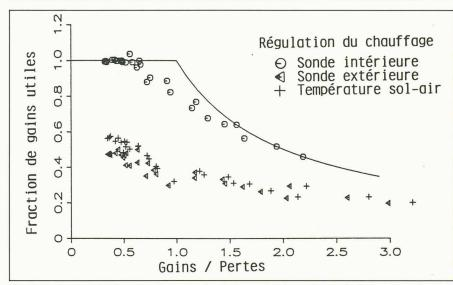
Fig. 2. — Facteur d'utilisation des gains de chaleur selon le mode de régulation (chauffage en mode continu).
