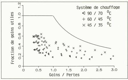
Fig. 1. - Facteur d'utilisation des gains de chaleur selon le système de chauffage.
