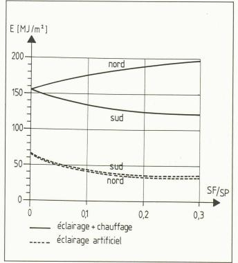
Fig. 3. – Consommation spécifique totale en énergie auxiliaire pour toute la saison de chauffage, en fonction de la surface relative de fenêtre et de l'orientation.
