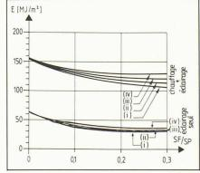
Fig. 9. — Consommation spécifique totale en énergie auxiliaire pour toute la saison de chauffage, en fonction de la surface relative de fenêtre et de l'utilisation des protections solaires. Pour: - vitrage isolant double sélectif
