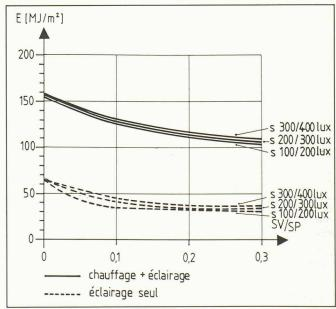
Fig. 1. — Consommation spécifique totale en énergie auxiliaire pour toute la saison de chauffage, en fonction de la surface relative de fenêtre et des niveaux d'éclairage choisis.
