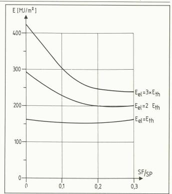
Fig. 2. — Consommation spécifique totale en énergie auxiliaire pour toute la saison de chauffage, en fonction de la surface relative de fenêtre et de la pondération introduite entre l'énergie électrique et l'énergie thermique.
