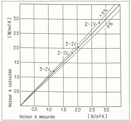
Fig. 2. – Comparaison de valeurs k, calculées et mesurées, pour différents vitrages.
