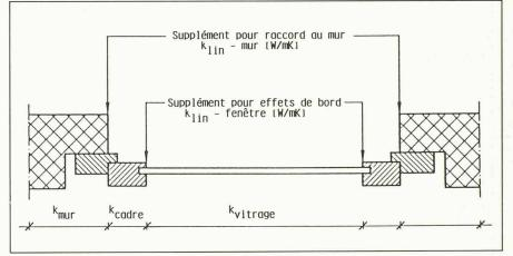
Fig. 1. - Zones caractéristiques de la fenêtre:
