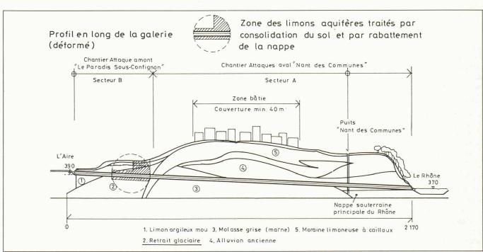
Fig. 2. - Profil en long avec sens des attaques.
