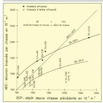
Fig. 3. – Efficacité des chasses. Flushing efficiency.
