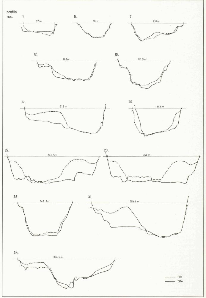
Fig. 5. – Evolution des profils en travers, de 1944 à 1981. Cross section evolution 1944-1981.
