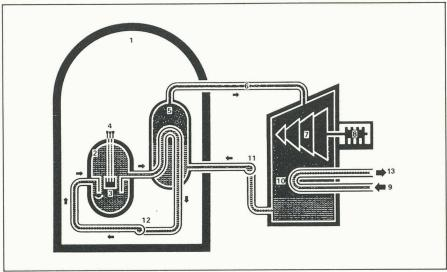
Fig. 1. – Réacteur à eau pressurisée (PWR).
