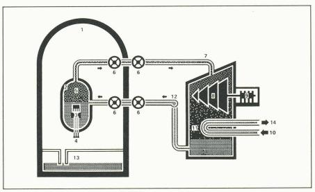
Fig. 2. – Réacteur à eau bouillante (BWR).
