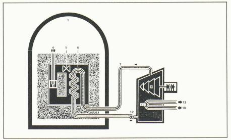
Fig. 3. – Réacteur à haute température au gaz (HTR).
