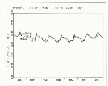
Fig. 5. – Evolution de la température au 1er étage, zone centrale.
