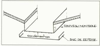
Fig. 6. – L'évacuation de l'humidité inexistante!
