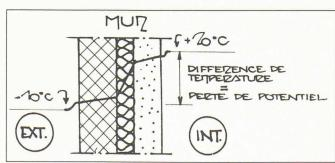
Fig. 1. – Diagramme des températures à travers un mur.
