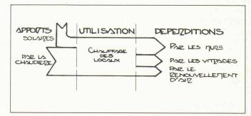
Fig. 2. - Bilan thermique du chauffage.
