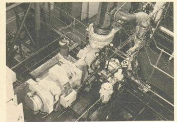
Turbogénérateur du système η- booster Sulzer subissant les tests avec le moteur diesel 9RTA58 destiné à l'île de Guernesey.
