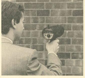
de 1 m, avec un diamètre de 20 mm pour l'objet à mesurer. L'angle de mesure est de 1,5°. L'appareil est équipé d'un signal sonore, qu'on peut mettre en service à volonté et qui permet de localiser les zones chaudes et les zones froides: plus la température s'élève, plus le son augmente. Le dispositif comporte également un réglage dit « de compensation d'émission », nécessaire pour mesurer les températures de surfaces reflétant la lumière à un haut degré.
