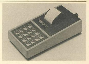
ron 500 heures ou 1000 lignes imprimées. Une fois l'appareil éteint ou les piles déchargées, la montre date/heure à alimentation séparée continue à fonctionner avec précision pendant 300 heures. L'utilisateur peut retrouver les accumulateurs et chargeurs de batterie nécessaires
