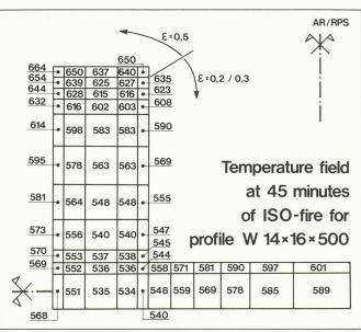
Fig. 5. — Champ des températures calculé à l'intérieur du profil d'acier  $W_{14} \times 16 \times 500$
