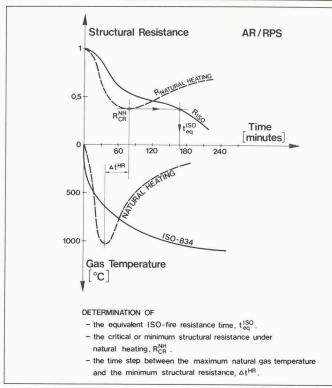
Fig. 15. - Concept du temps de résistance ISO équivalent.
