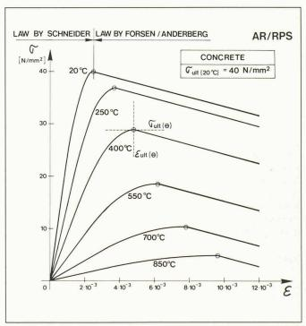
Fig. 2. — Diagramme contraintes-dilatations du béton à diverses températures.
