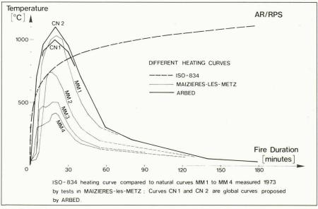
Fig. 13. – Courbes d'échauffement naturel MM1 à MM4, comparées à la courbe ISO-834.
