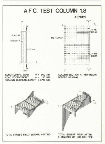
tées avec une extrémité simplement appuyée et l'autre extrémité pratiquement encastrée. Dans les deux cas, une rotule plastique prévue par la simulation numérique fut observée à proximité de l'encastrement. Les temps de résistance au feu selon le critère de la flèche  $f \leq L/30$ , calculés suivant Ceficoss et mesurés au cours des essais, concordent parfaitement. La figure 7 montre l'évolution de la flèche mesurée et simulée pour la troisième poutre testée.
