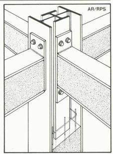
Fig. 20. — Construction mixte AF avec assemblages poutrelle-colonne.
