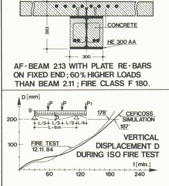
Fig. 7. — Flèche mesurée et calculée à mi-portée d'une poutre mixte appuvée-encastrée.
