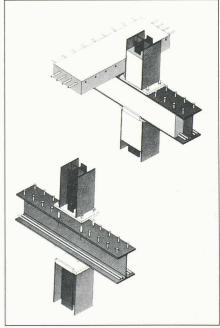
Fig. 21. — Eléments mixtes AF complètement préfabriqués.
