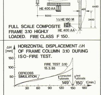
Fig. 8. — Colonne et poutre du type de cadre testé avec déformation latérale de la colonne.
