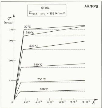
Fig. 1. — Diagramme contraintes-dilatations de l'acier à diverses tempé-
