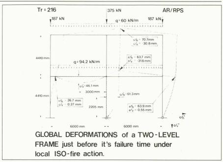
Fig. 12. – Déformation globale d'une ossature à deux niveaux.
