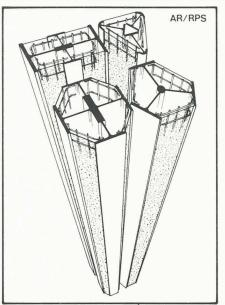
Fig. 19. — Colonnes mixtes à sections transversales polygonales avec surfaces en acier visibles.
