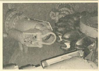
Vue partielle d'une turbine Pelton à axe vertical.
