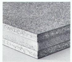
Les éléments HOMISOL DUO sont constitués de deux panneaux de particules collés sans formaldéhyde et d'une mousse intermédiaire de polyuréthane résistant à la compression. Ils sont résistants au trempage d'imprégnation et peuvent être surfacés, plaqués ou peints à volonté. La structure sans entretoise garantit un coefficient k uniforme de transmission de chaleur.
