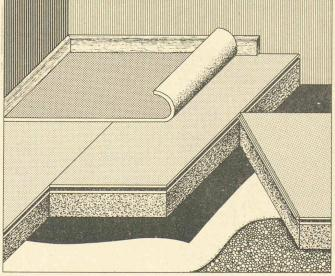
Construction d'un plancher sec en panneaux d'isolation contre les bruits d'impacts Pavatex Duro.
