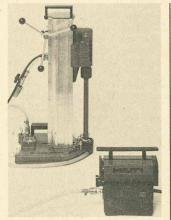
Appareil de forage DCMI au diamant pour des trous de chevilles dans du béton fortement armé.
