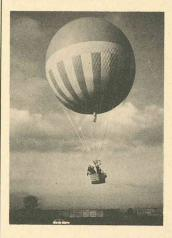
Enduit à raison de 65 grammes par mètre carré sur la face externe d'un tissu polyester, le caoutchouc «Hypalon» permet ainsi de fabriquer des ballons alliant performances et sécurité.
