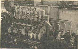
Moteur diesel RTA pour la propulsion marine au banc d'essai de l'usine de Winterthour
