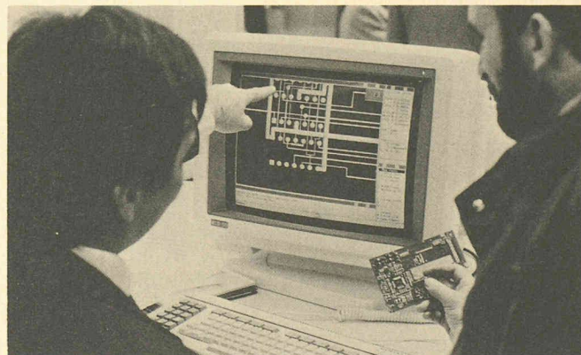
Le système de conception Sitest 300 de Siemens comprend l'ensemble de l'étude de composants et modules électroniques, depuis l'introduction du schéma jusqu'à la préparation du test de composants et modules, en passant par la simulation de placement. Siemens a ainsi réuni pour la première fois les tâches d'étude et de test, car le test ultérieur est pris en considération dès le stade du projet.
