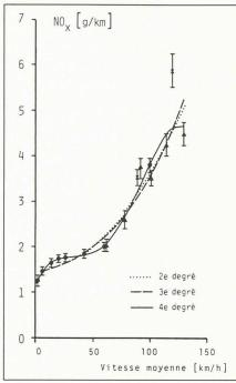
Fig. 2. — Influence de la vitesse moyenne sur les coefficients d'émission d'oxydes d'azote des voitures de tourisme (régressions polynominales des 2°, 3° et 4° degrés).
