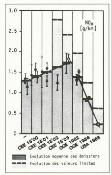
Fig. 1. — Evolution des émissions d'oxydes d'azote et des valeurs limites en fonction des étapes successives des prescriptions (méthode de référence: FTP 75).
