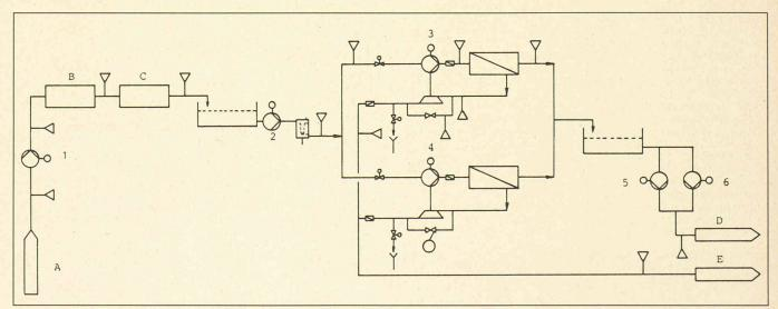
Schéma des installations de dessalement d'eau de mer équipées de pompes Sulzer Weise.
