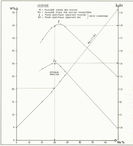
Fig. 2. – Humidité et poids spécifiques apparent et sec des scories après compaction.
