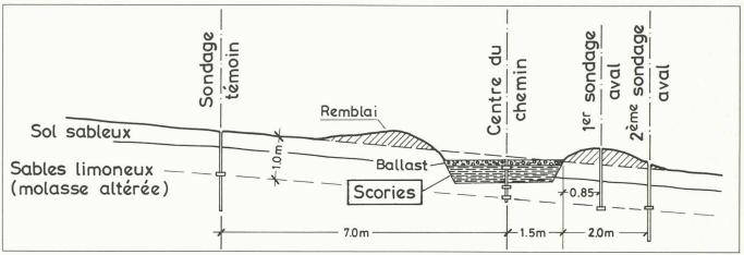
Fig. 1. - Coupe du chemin et position des sondages.
