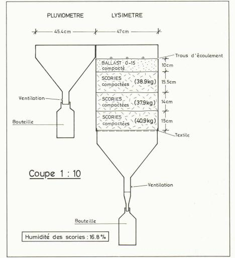
Fig. 3. – Essai de lixiviation: dispositif expérimental.
