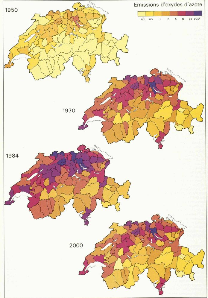
Fig. 8. – Evolution des émissions d'oxydes d'azote du trafic routier en Suisse de 1950 à 2000 (tonnes par unité de surface brute).
