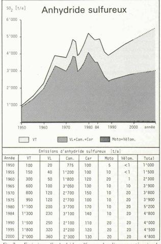
Fig. 7. – Emissions d'anhydride sulfureux des diverses catégories de véhicules de 1950 à 2000.
