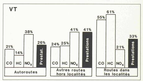
Fig. 3. — Comparaison entre les émissions et les prestations de circulation des voitures de tourisme en 1984.
