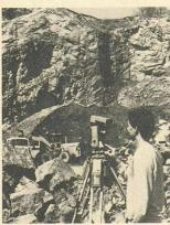
combinaison d'instruments DI3002, théodolite électronique Wild T1000, terminal de terrain Wild GRE3 et logiciel DIOR permet de déterminer avec précision le déblai d'une carrière.
