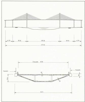
Fig. 17. - Pont de Neches, dimensions.
