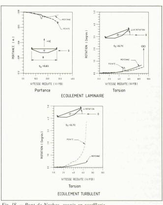
Fig. 18. - Pont de Neches, essais en soufflerie.
