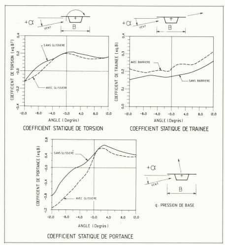
Fig. 14. - Pont du Sunshine Skyway, essais en soufflerie.
