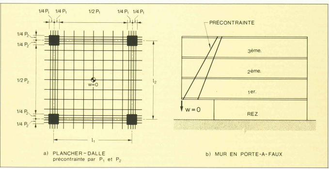
Fig. 3. – Critère de flèche nulle ou petite d'une structure précontrainte.
