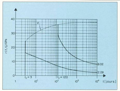
Fig. 2. – Exemple de deux fonctions relaxation pour un béton situé en plein air (H.R. 70%), épais de 40 cm.
