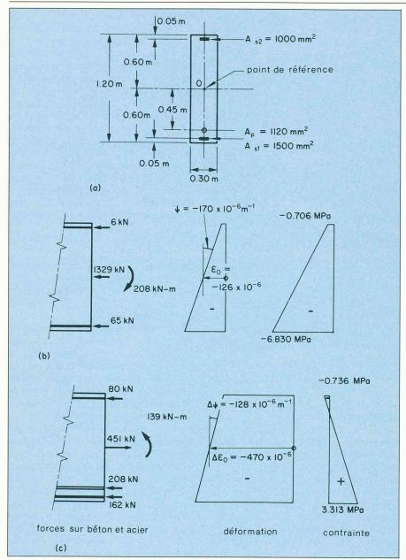
Fig. 5. – Contraintes et déformations dans une section précontrainte
