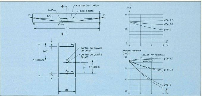
Fig. 8. - Moment balancé au temps t∞.
