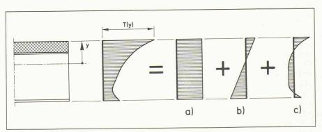
Fig. 1. – Décomposition d'une distribution de température :
