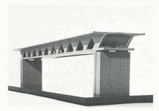
Fig. 18. — Tablier à âmes évidées avec précontrainte extérieure.
