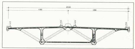
Fig. 4. - Coupe transversale du pont d'Elbeuf (projet SETRA/SECOA).
