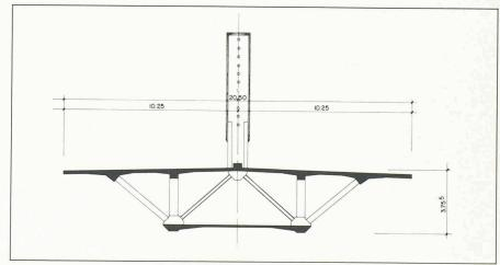
Fig. 24. – Viaduc de l'Arrêt-Darré: coupe transversale (projet SECOA).
