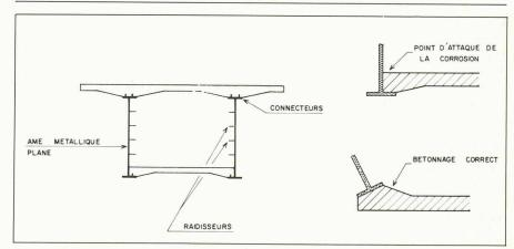
Fig. 5. — Position de la membrure inférieure en béton par rapport aux semelles des âmes métalliques.
