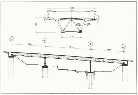
Fig. II. — Pont d'Arbois; coupes longitudinale et transversale (projet Dragages et Travaux Publics et Société Générale d'Entreprises).
