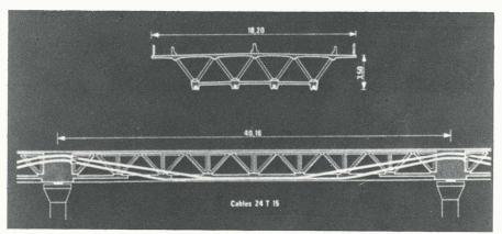
Fig. 13. – Pont de Bubiyan; coupe longitudinale avec câblage, coupe transversale (projet Bouygues).
