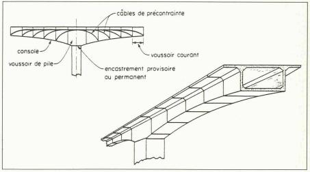
Fig. 5. - Principe général de la construction par encorbellement.
