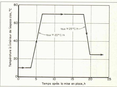
Fig. 1. - Cycle d'un traitement thermique pour cure accélérée du béton.
