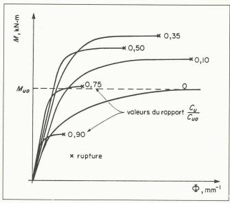
Fig. 13. - Relations moment-courbure d'une section travaillant en compression-flexion.
