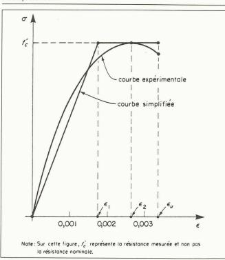
Fig. 7. - Courbes contrainte-déformation du béton.
