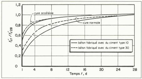
Fig. 2. - Résistance du béton en fonction du temps.
