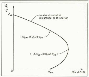
Fig. 14. - Courbe d'interaction flexion-compression obtenue de la fi-
