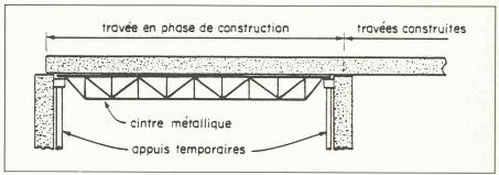
Fig. 4. - Construction travée par travée sur cintre autoporteur.
