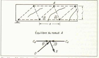
Fig. 10. - Modèle du treillis: armature transversale inclinée.
