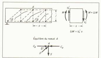
Fig. 9. – Modèle du treillis: armature transversale verticale.
