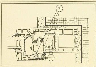
Fig. 3. — Des fenêtres en plastique devraient normalement être munies de renforcements métalliques. Ceux-ci servent non seulement à assurer le raidissement indispensable, mais aussi à garantir un ancrage durable des ferrements fortement sollicités fonctionnellement (B).
