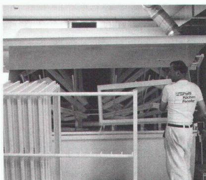
Nous attachons une immense importance au traitement, exécuté dans les règles de l'art, des surfaces des fenêtres Piatti. Par rapport aux techniques normales, chez Piatti, les cadres et les vantaux sont trempés intégralement et sans ferrures dans un bain de longue durée. De cette façon, la couche de fond peut pénétrer plus profondément et plus intensivement dans le bois. D'où la garantie optimale que le bois sera protégé des intempéries, de la pollution et l'humidité.
