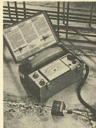
Une entreprise suisse a développé un nouvel instrument de mesure — le Profometer — dont le domaine de mesure a été élargi à cet usage. Le Profometer dispose de deux sondes de mesure avec chacune des caractéristiques de mesures différentes.
