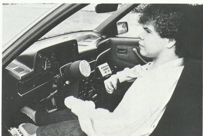
Les leviers sont aménagés de telle façon que, selon le genre du handicap physique, ils puissent être déplacés vers l'avant, l'arrière ou latéralement, à l'aide d'une épaule ou d'un pied.
